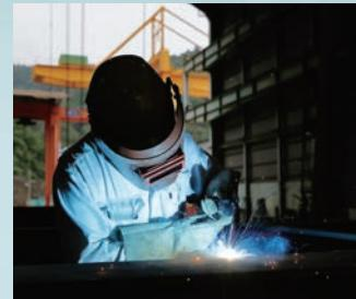
私が担当している製缶・溶接とは、鋼板を切断・曲げ加工・溶接を行い産業機械の構造物を製作するのが主な仕事内容です。当社の製作している製品のスケールの大きさと元々ものづくりに興味があったことから入社を決めました。
